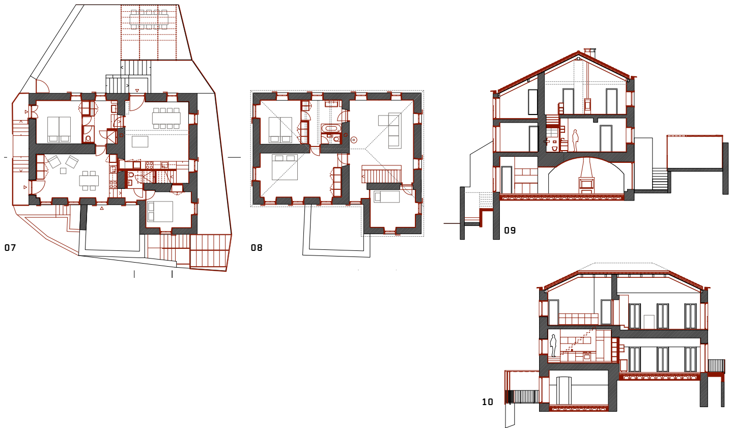
07–08 Grundrisse Erdgeschoss und Obergeschoss. Die Interventionen durch Met Architektur sind rot eingezeichnet; Massstab 1:300. (Pläne: Met Architektur)
